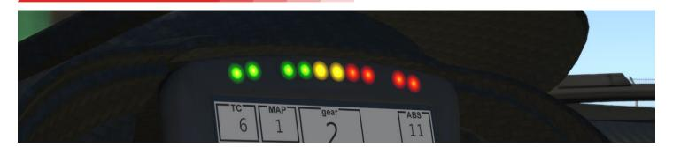
1 GREEN 6650rpm **2 GREEN** 6800rpm **3 GREEN** 6950rpm **4 GREEN** 7100rpm 1 YELLOW 7250rpm 2 YELLOW 7400rpm 1 RED 7550rpm **2 RED** 7700rpm 3 RED 7850rpm 4 RED 8000rpm
